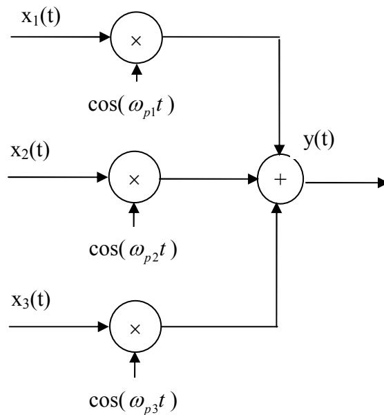
Unde semnalele  $x_1(t)$ ,  $x_2(t)$  si  $x_3(t)$  au spectre de banda B, reprezentate in figura de mai jos:
