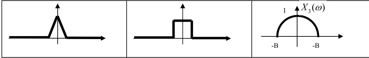
Sa se determine o relatie intre  $\omega_{p1}, \omega_{p2}, \omega_{p3}$  si B astfel incat semnalele  $x_1(t)$ ,  $x_2(t)$  si  $x_3(t)$  sa poate fi reconstruite la receptie. Utilizand relatiile obtinute sa se reprezinte grafic spectrul semnalului  $y(t)$  si sa se schiteze o modalitate de receptie a semnalului  $x_2(t)$ .
