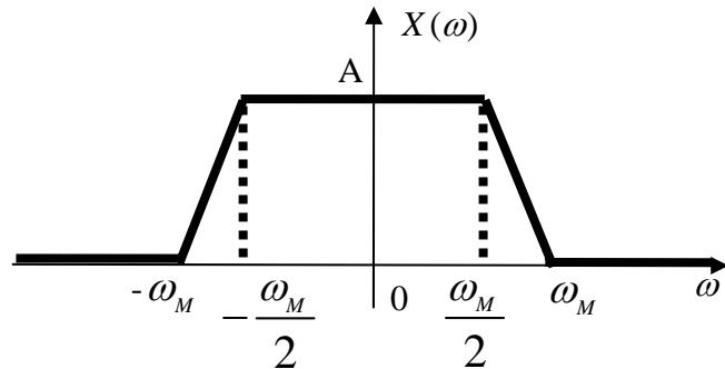
sa se reprezinte spectrul semnalurilor  $x(t)e^{j\omega_0 t}$  si  $x(t)e^{-j\omega_0 t}$  pentru cazurile a)  $\omega_0 = 5\omega_M$  si
