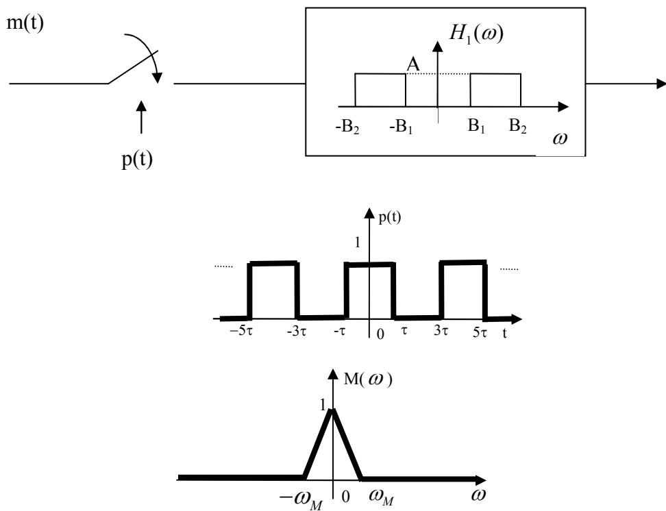
Să se determine relația dintre  $B$ ,  $B_1, B_2, \omega_m, \omega_p, k, T$  astfel încât să fie îndeplinită condiția  $y(t) = k \cdot m(t) \cos(\omega_p t)$ .
